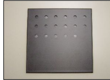
FIG.2 平底穴サンプル
