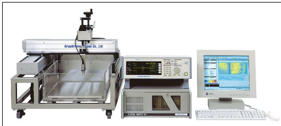
FIG.3 超音波探傷装置映像化装置 D-view
